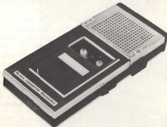
Fig. 6 - Uno degli ultimi esemplari di produzione Narita, con sistema di trascinamento a «capstan».
