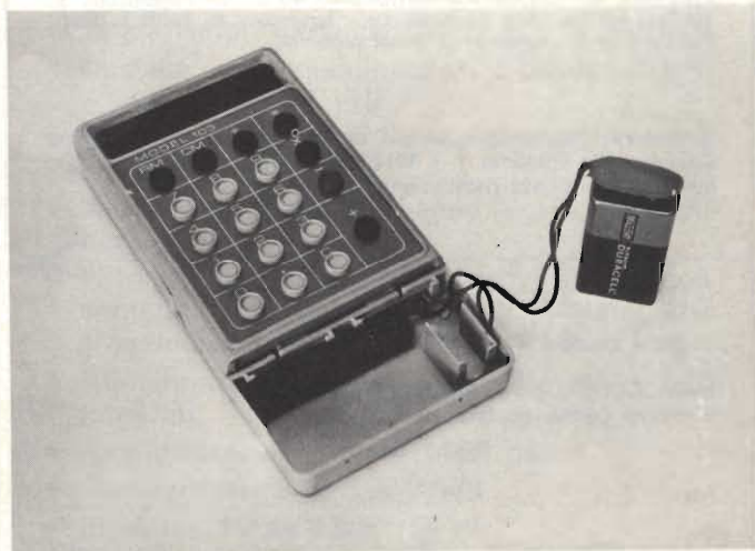
Fig. 1 - La calcolatrice di cui ci siamo serviti per scattare il nostro documentario fotografico è una UNICOM PRECISA Modello 103 capace di effettuare solo le quattro operazioni. La si vede qua ancora tutta montata. Solo è stato scopercchiato l'alloggio della pila.
