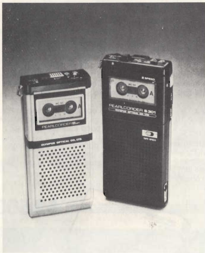
Fig. 1 - Due moderni tipi di registratore a mini-micro cassette, entrambi di produzione Olympus.
